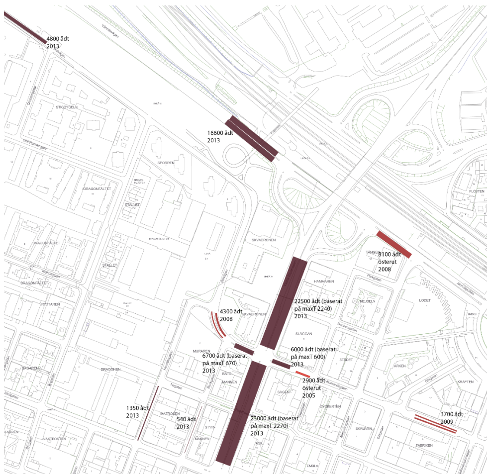
Figur 2.4 Illustrationen visar de sträckor där trafikmätningar finns tillgänglig samt vilka trafikflöden snitten har. Trafikflödena illustreras även med olika breda linjer, där vissa snitt har en linje för varje trafikriktning 3 .
